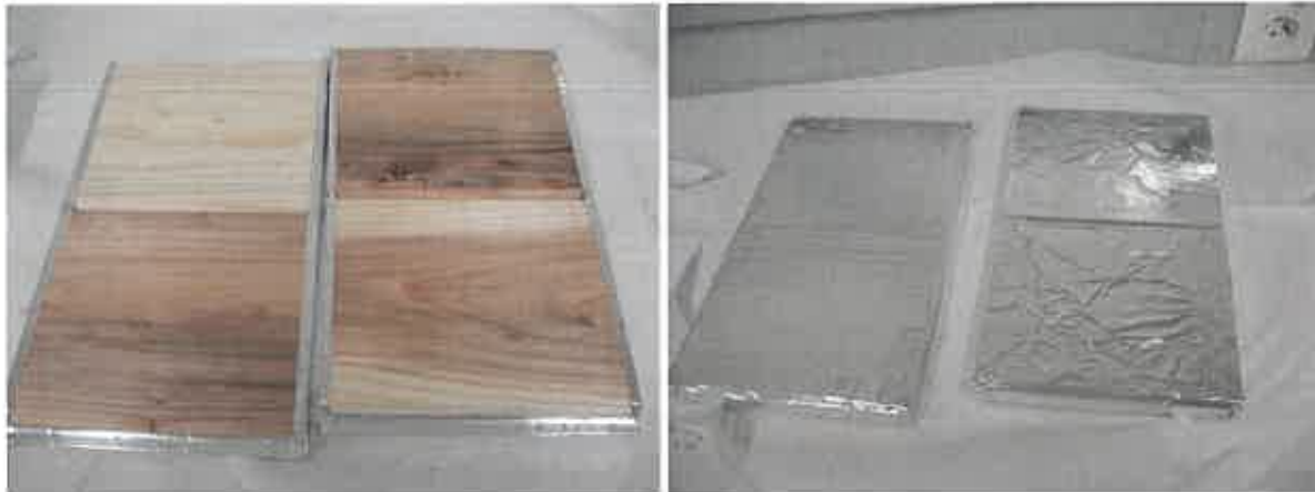
Photo 2 : Eprouvettes d'essai après colmatage
