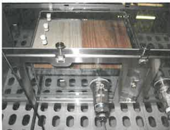
Photo 3 : Epruvettes conditionnées dans la chambre d'essai d'émission
