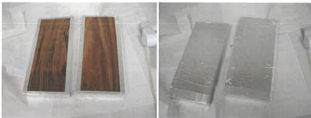
Photo 2 : Eprouvettes d'essai après colmatage
